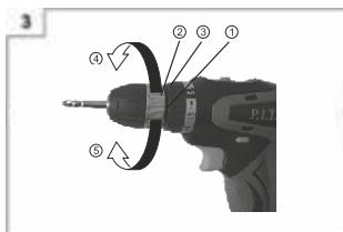
Проверьте правильность установки переключателя крутящего момента шпинделя. При использовании инструмента как шуруповерт, установите одну из цифр «1, 2, 3...18» на переключателе или черную
