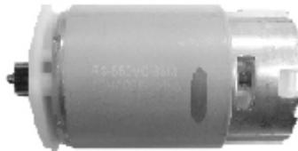
постоянного тока состоит из цилиндра, внутри которого располагаются постоянные магниты. Внутри цилиндра на втулках-опорах из латуни располагается якорь двигателя выполненный из электротехнической стали имеющая высокую магнитную проницаемость.
